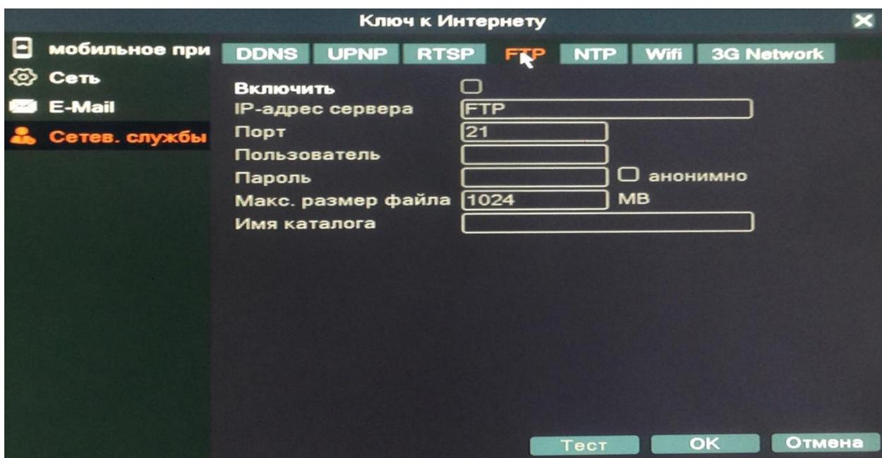
Настройки FTP (стандартный протокол, предназначенный для передачи файлов по сети интернет)
