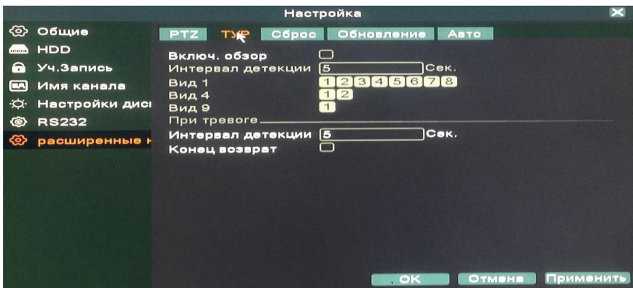
Эта функция предназначена для настройки автоматической смены отображаемых каналов.
