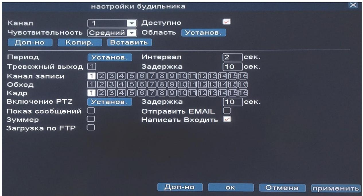
**Канал:** Выбор канала, на котором будет фиксироваться движение
