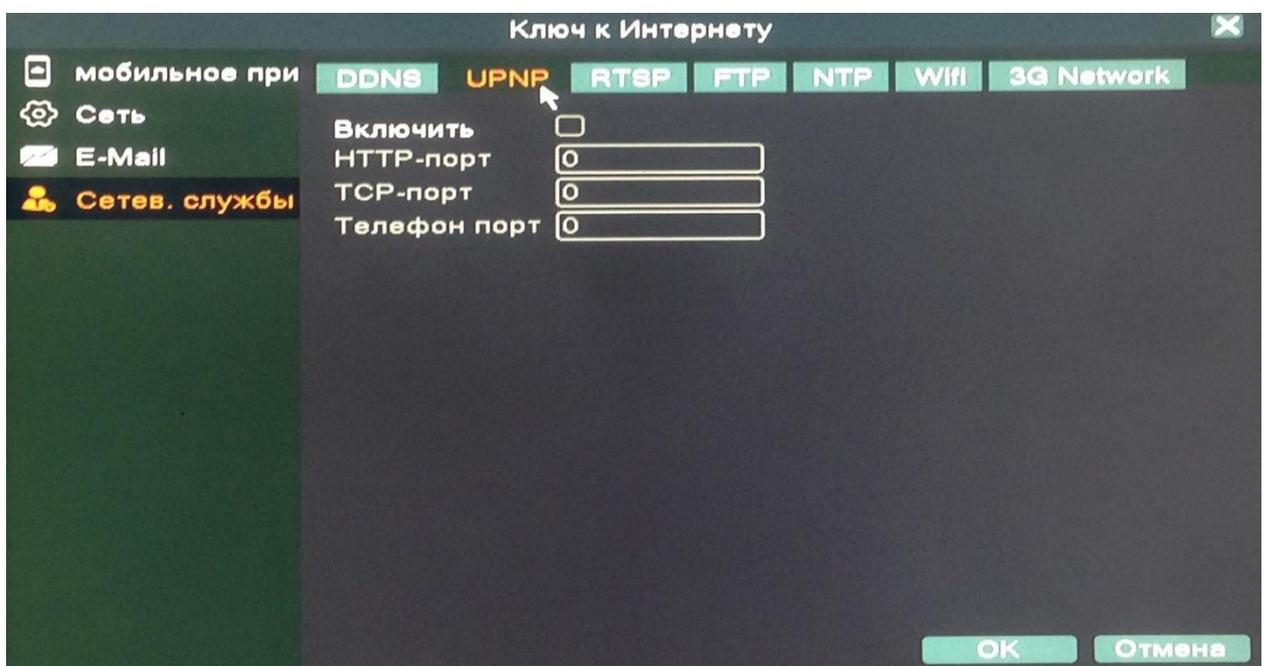
Настройки UPNP (набор сетевых протоколов. Цель UPNP — универсальная автоматическая настройка сетевых устройств, как дома, так и в корпоративной среде).
