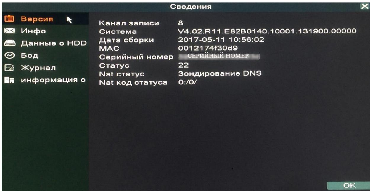
Основные сведения о количестве каналов видеорегистратора, версии прошивки, дата сборки, дублируется серийный номер, статусы устройства.
