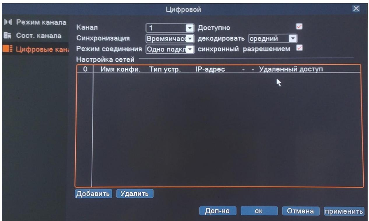
Настройки адресов, портов для IP камер.
