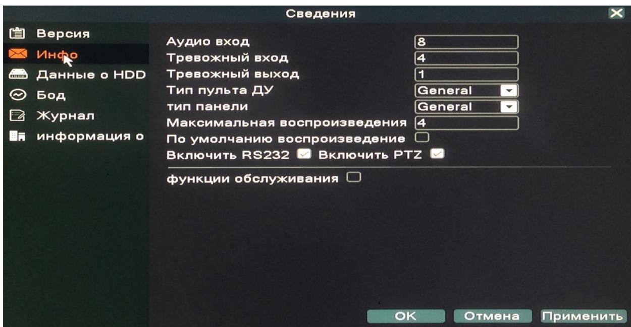
Информация о количестве: аудио входов, тревожных входов и выходов, одновременно воспроизводимых каналов. Переключение типов пульта ДУ и панели, RS232, PTZ.
