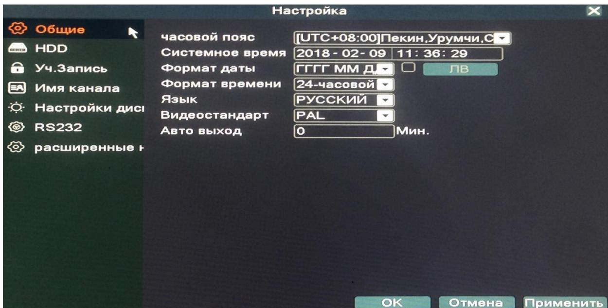
Настройки времени, даты, часового пояса. Изменение языка. Видеостандарт PAL или NTFS. Установка времени для автоматического выхода из системы.
