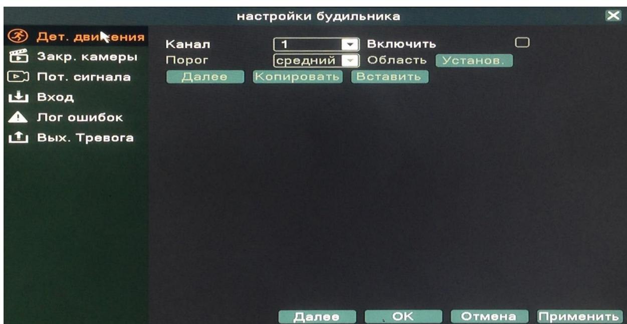
**Детектор движения:** срабатывает камера при движении.
