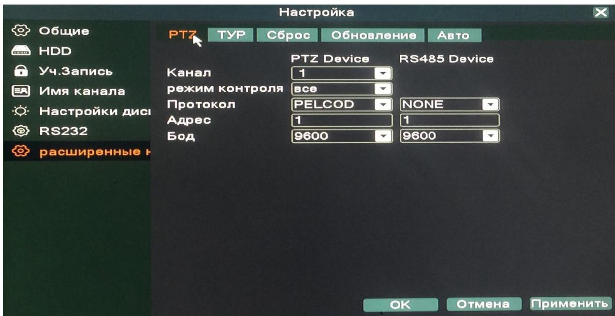
Эта функция предназначена для управления поворотными камерами по интерфейсу RS-485.
