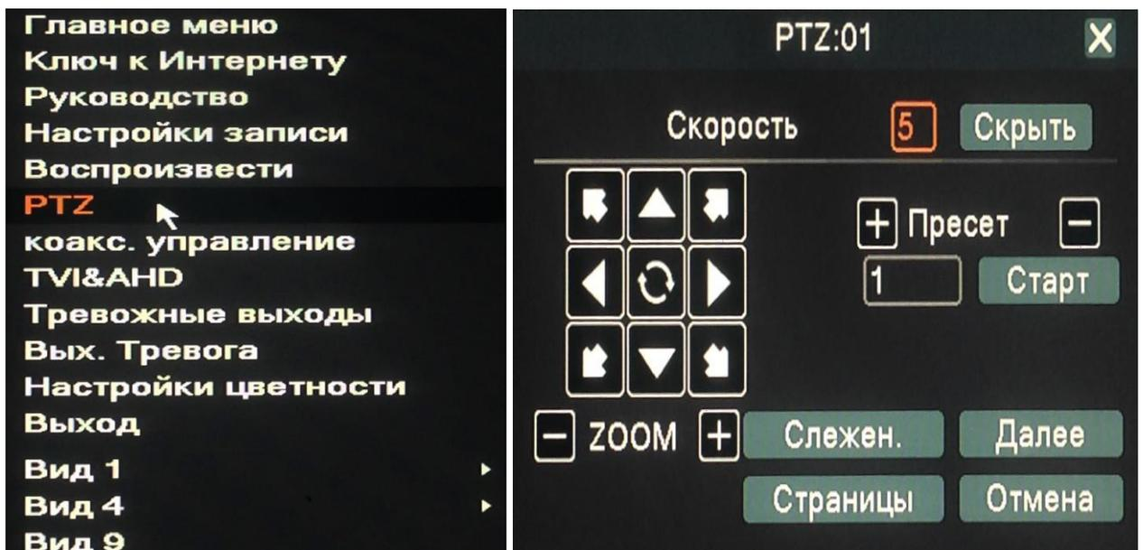
Управление камерами с PTZ (камера, которая поддерживает удаленное управление направлением и зумом).
