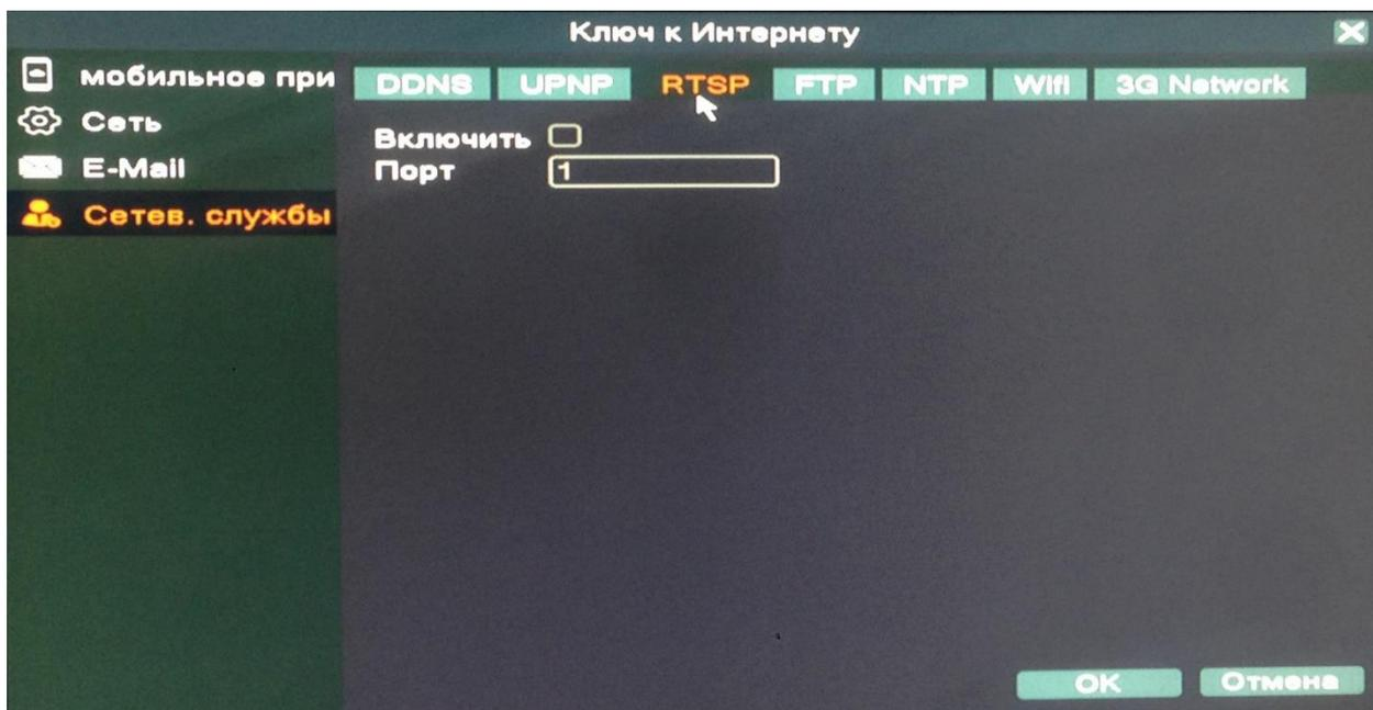
Настройки RTSP (прикладной протокол, позволяющий удалённо управлять потоком данных с сервера)
